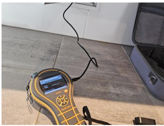
Utført kontroll i tilliggende konstruksjon - Fuktmåling bad 2. etg.
